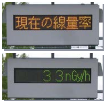
図2: モニタリングポストの液晶パネルの様子。通常、原子炉実験所周辺の放射線量は30~100nGy/hを示します。
