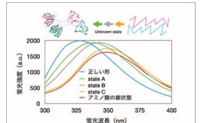
図4. 蛍光分析によるβB2-クリスタリン蛋白質(眼内水晶体の主要構成蛋白質の一つ)の溶液中での再生過程の観察。各段階におけるピークの強度などから再生程度は判断できるが、各形態は不明である。
