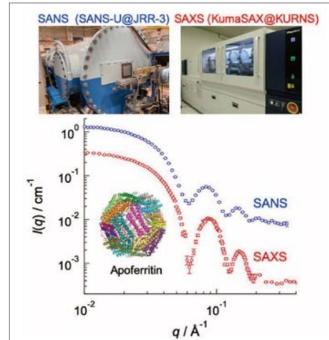
図2. SANS-U@JRR-3及びKumaSAX@KURNSで計測したアポフェリチン希薄溶液のSANS及びSAXSプロファイル。測定時間はSANS(青丸)が1時間、SAXS(赤丸)が2時間半。
