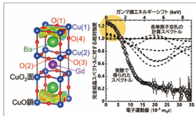
図1 GdBCO完全結晶の構造と陽電子密度分布(左)、陽電子消滅ガンマ線エネルギースペクトルの実験値および計算値(右)。
