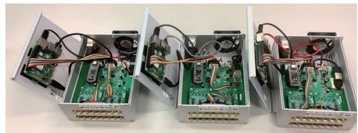
Raspberry Piを制御に使用したビームロスモニタの読み出し系
