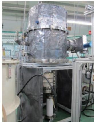
図1 D-D中性子発生装置
