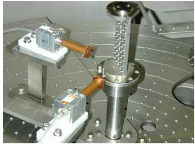
図2 45度に配置された2台の 荷電粒子検出器
