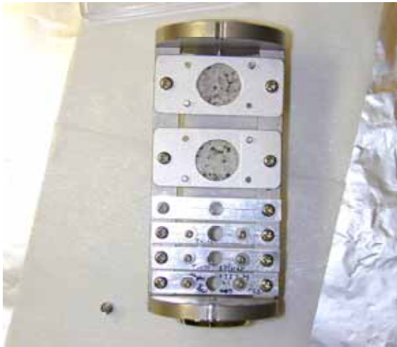
図1 ターゲット支持台に装着した 花崗岩サンプル
