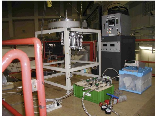
第 8 7 図 水素吸蔵合金の in situ 実験例 (KEK/KENS)
