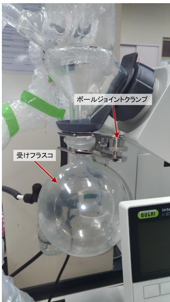
Fig. 3-6 回収 D 2 O が受けフラスコに貯まる
