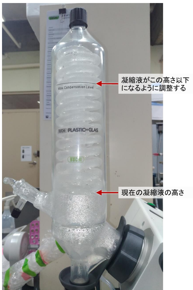
Fig. 3-3 冷却コンデンサー内の凝縮液の高さ
