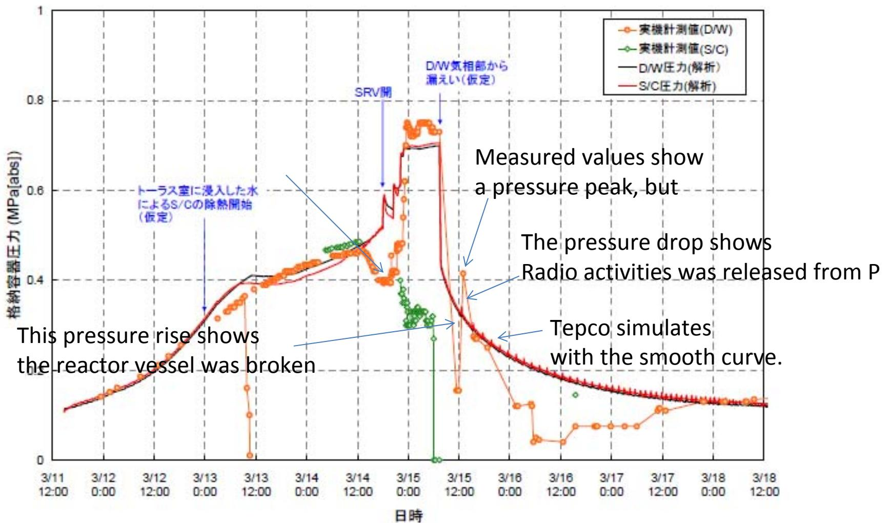
図 3-3 2号機 格納容器圧力変化
