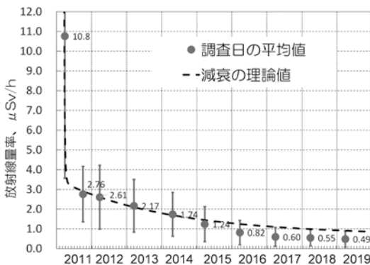
図2 飯館村の主要な道路上での走行サーベイに基づく平均放射線量の推移。 ●が測定値で、縦棒はそのバラツキ(標準偏差)。破線は、沈着した放射能が移動しないという仮定の下での理論的減衰曲線。
