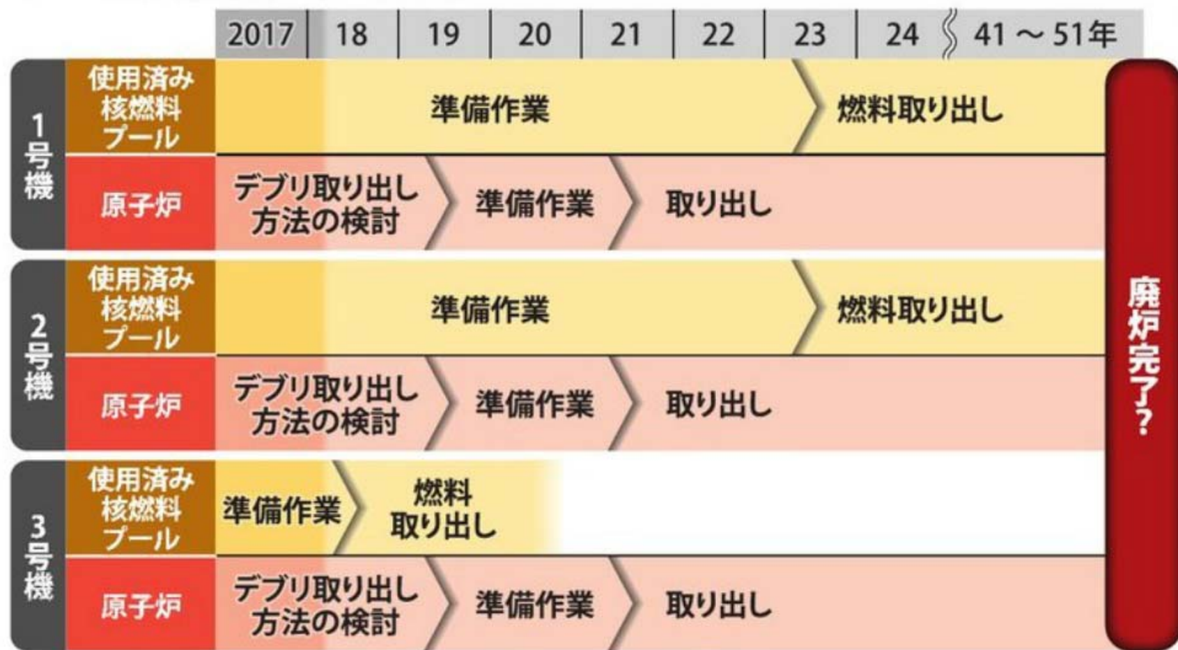
1～3号機廃炉の工程表 ※各号機とも最速で進んだと想定した場合のスケジュール
