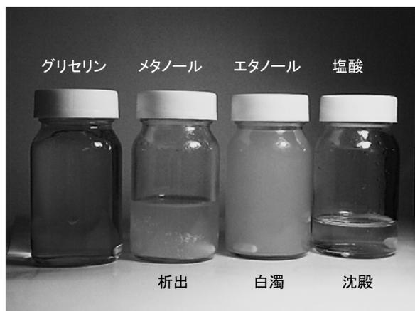
図1. ゲル化試験(SMC 10ml, 中和滴定による)
