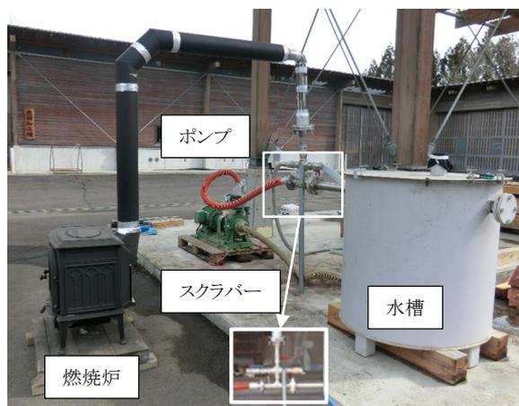
図2 燃焼ガス処理システムの外観、挿入写真はスクラバー、下段はジェット水流、上段は三口コネクター
