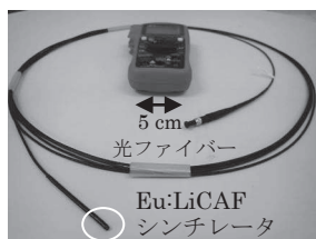
図 1 光ファイバー一体型 Eu:LiCAF 製中性子検出器
