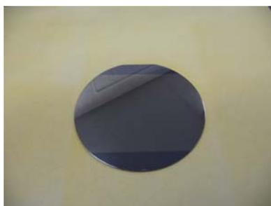
Fig. 1.  $Ti_{25}Cr_{35}V_{40}$  alloy membrane.
