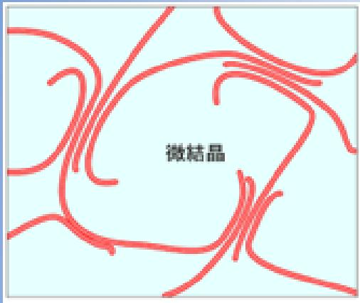
物理的な力(水素結合・疎水性相互作用・ファンデルワールス力etc.)で架橋したゲル。
