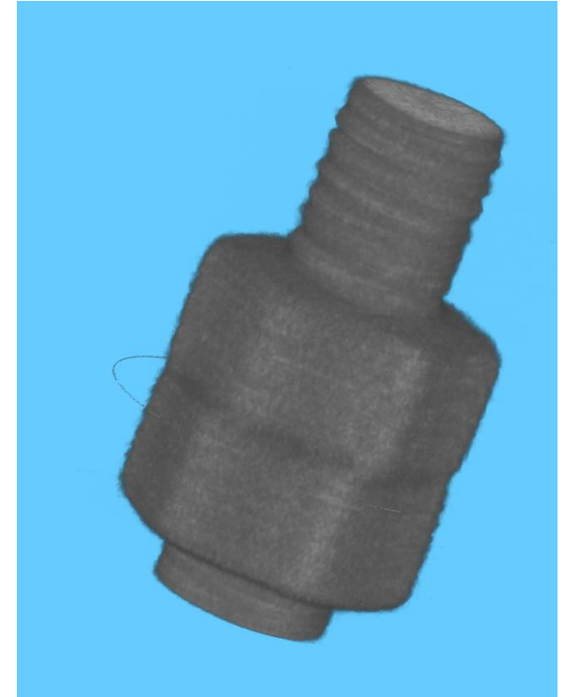
ボルト・ナットの CT 再構成結果
