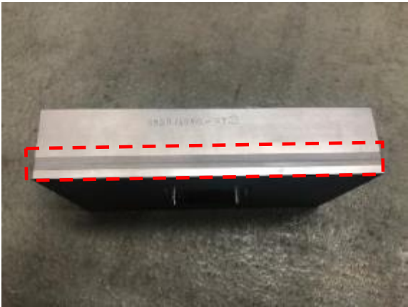
拡散接合で構成された直交流路
