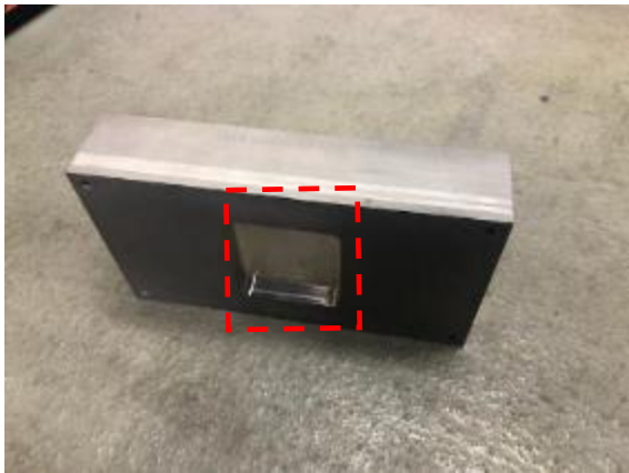
中性子照射部に切削 (中性子線の減衰を最小限)
