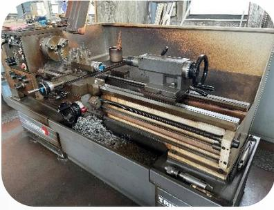
材料を掴むためのチャック部(治具)は、外形がΦ220程度の部材まで使用可能です。主に真空機器に取り付ける溶接フランジやパイプ、丸型のサンプルホルダーなどを製作しています。
