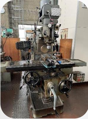
ブロック状の部品や板の側面仕上げに使用しているが、ドリルを用いた加工にも対応しています。材料の固定方法として、機械のテーブルや油圧バイスを用いるため、角材の加工に対しての汎用性に優れています。
