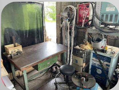
パイプとフランジの接合や板の接合に使用しています。この溶接機を用いて、主に真空容器や密封容器、液体を使用する実験装置を製作しています。
