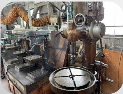
ドリルを使用することにより、様々な形状の材料に穴を開けることができます。穴の種類としては、貫通穴や深さ指定の穴、ネジの頭部を沈み込ませるための穴などの加工が可能です。
