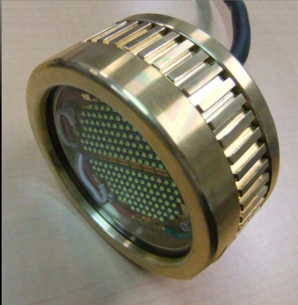
LEDを実装したFGHP基板（日亜化学工業社製白色）
