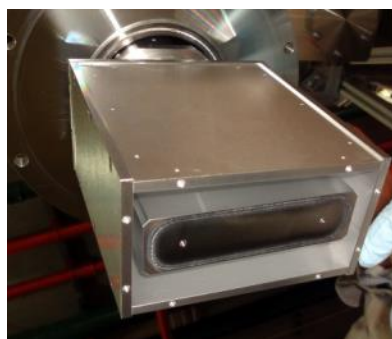
メシチレン容器底部 (ラディエーションシールドの 底を開けたところ)
