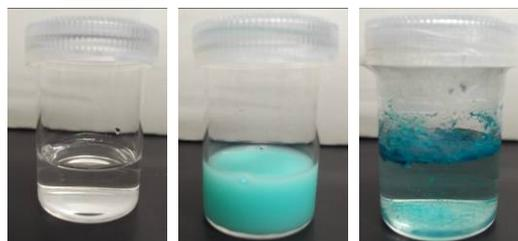
図4 1.0 wt%オレイン酸ナトリウム水溶液へ塩化銅(II)溶液 (a)0.0, (b)0.1, (c)0.2 wt%添加
