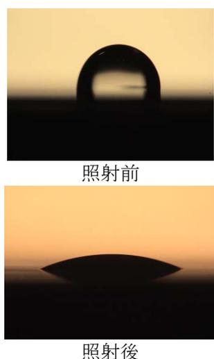
Fig. 3  $\gamma$  線照射前後の液滴の様子
