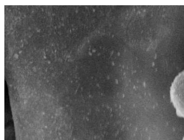
Fig.4 窒素吸蔵後の SUS316L 粉末の SEM 画像
