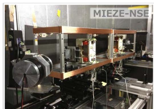
図 2. VCN キャビン内に設置した MIEZE 型 NSE 装置
