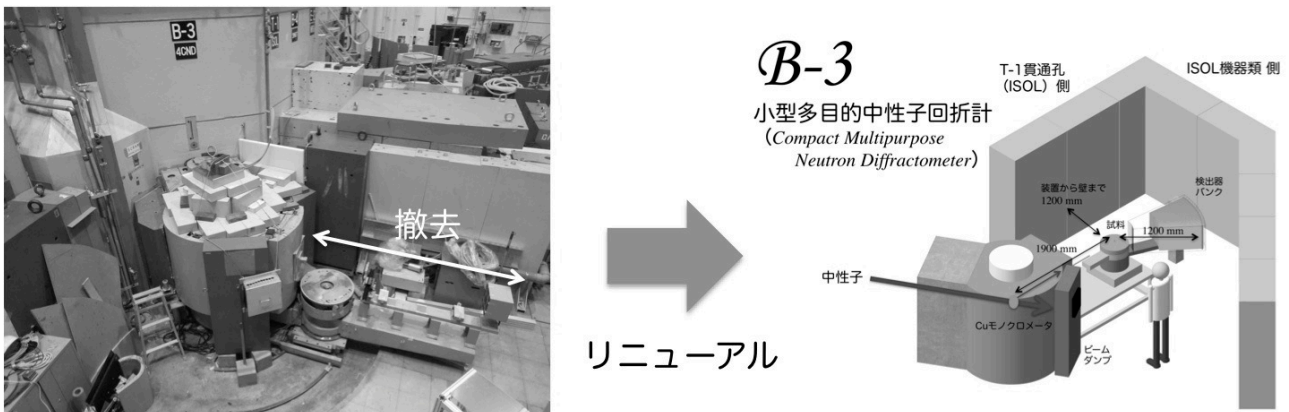
図1 既設の単結晶用4軸中性子回折計4CND (左図) と小型多目的中性子回折計のイメージ図 (右図)。
