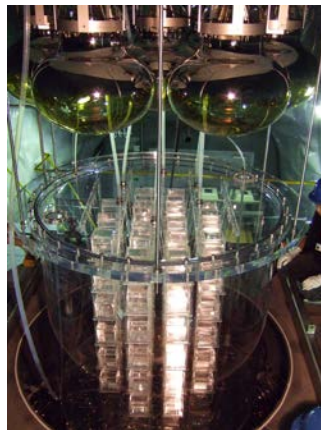
図 1. 東京大学宇宙線研究所・岐阜県神岡地下 1km に建設された CANDLE(Calcium fluoride for studies of Neutrino and Dark matters by Low Energy Spectrometer)実験装置にマウントされる \text{CaF}_2 結晶。
