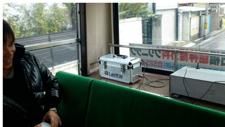
図 5 福島交通のバスに搭載した KURAMA-II
