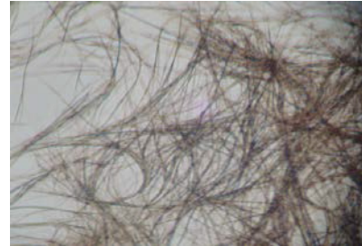
図4 ジョロウグモ由来化学合成ペプチドの線維 2) ジョロウグモ消化酵素の機能解析
