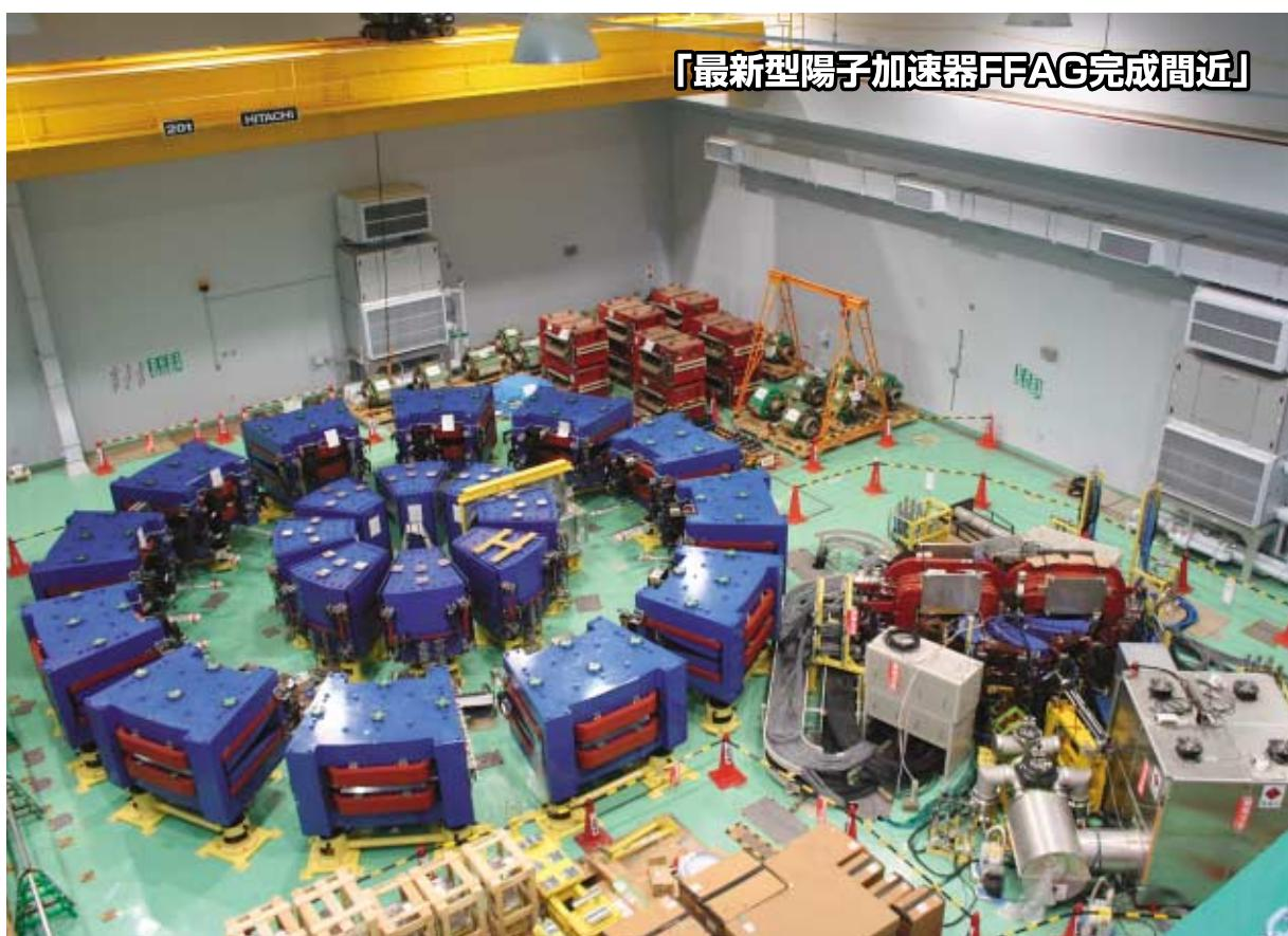
FFAG(Fixed Field Alternating Gradient) 加速器は新しいタイプの加速器です。陽子を加速するこの加速器によって未臨界炉を駆動し、より安全なエネルギー供給システムを実現するための基礎研究などを行おうとしています。
