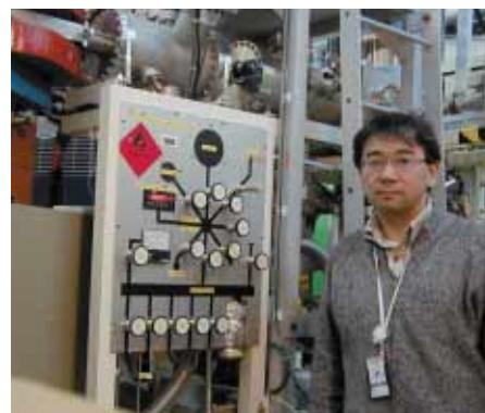
実験装置の前で。上方にビームが通るダクトが見えている。頭上辺りの真空容器の中で、原子とミュオンが出会い、ミュオン原子が生成される。
