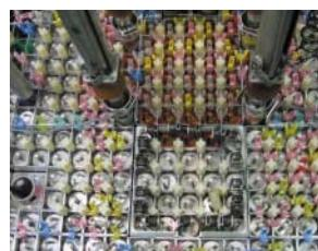
KUCAで構築したエルビア入り超高燃焼度原子炉の模擬体系。同種の体系としては世界初の臨界実験に成功した。
