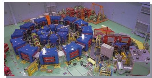
加速器駆動未臨界炉研究のためのFFAG陽子加速器
