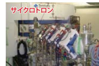
世界初のBNCT用サイクロトロンと中性子照射システム
