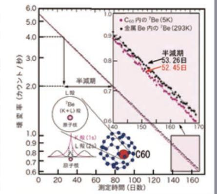
温度5KにおけるC60に内包された<sup>7</sup>Beおよび金属Be内の<sup>7</sup>Beの壊変率と測定時間の関係(壊変曲線)。図内にK殻(1s)とL殻(2s)の動径分布関数を示す。
