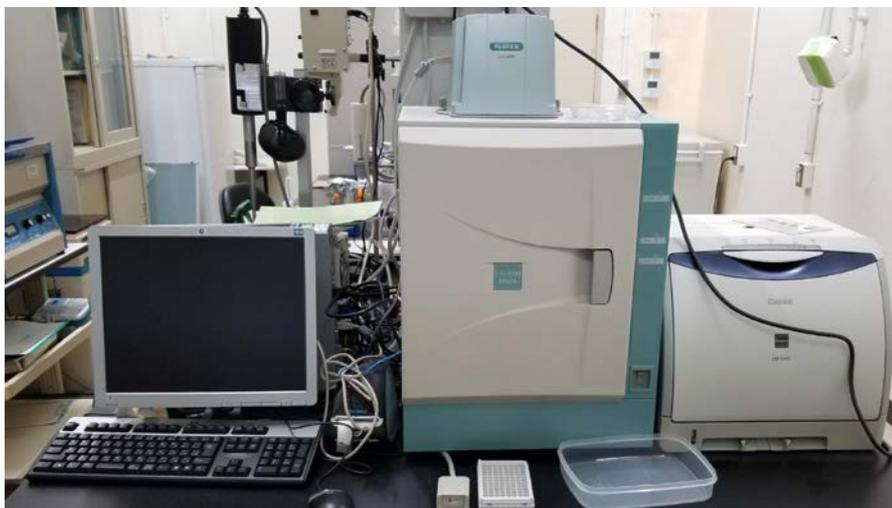
4000EPUVmini。化学発光、蛍光検出、可視検出に対応する冷却 CCD カメラを備える。RIの使用不可。使用前に装置担当者と必ず打ち合わせすること。
