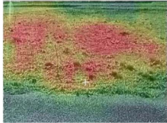
図5. ガンマカメラによる放牧地汚染のばらつき 手前舗装道路路。赤が厚汚染。
