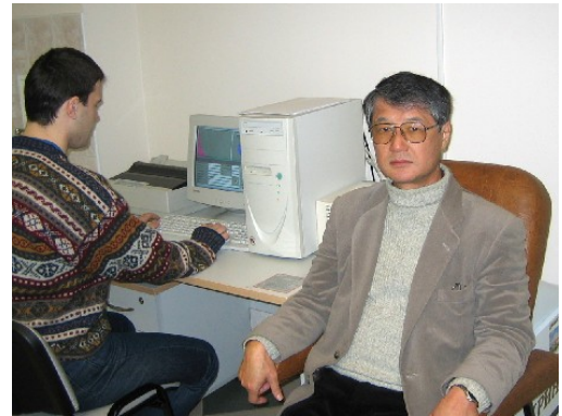
ベルラドの体内放射能測定装置：椅子の背もたれにNaIガンマ線検出器が入っている。セシウム137の検出限界は体重1kg 当り5ベクレル程度。2004年12月。
