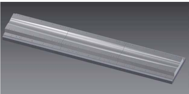
Fig. 1. 光学素子の製作図面。ミラー面は回転楕円体 (長軸；1250mm、短軸；65.4mm)
