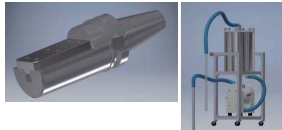
Fig. 2. 開発中の工具ホルダー (左)、および切り粉除去装置 (右)
