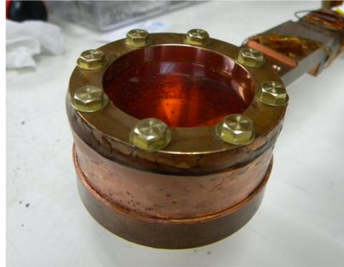
Fig. 2  $\mu$ SR測定に使用した $\text{D}_2\text{O}$ 試料
