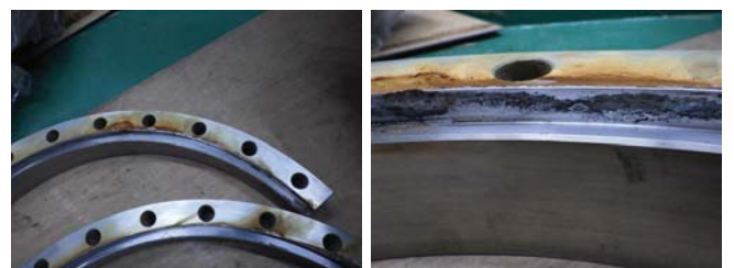
今回新たに見つかった腐食
