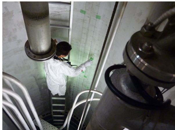
図4 タンク内超音波測定
