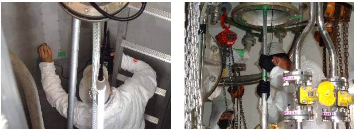
図3 炉心タンク等肉厚測定の様子
