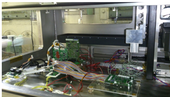
Fig. 2 カリフォルニウム照射試験装置の内部の様子
