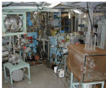
KUR-ISOLの2つのビームコースの写真。 左側にテーブルコルレクタを設置した核物理コース、右側に後段加速器を設置した物性コース。
