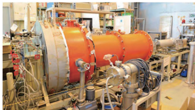
中性子小角散乱装置(CN-2実験孔)
