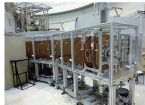
KURのB-1実験孔に設置された原子炉ベース低速陽電子ビームシステム
