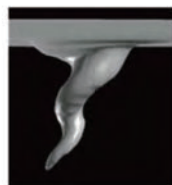
気液二相流の高精度数値解析例 (気液界面の複雑変形挙動)
