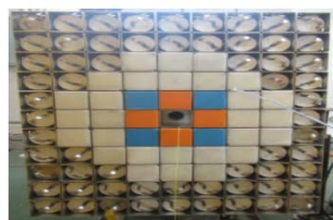
U-Mo合金HALEU燃料を用いた未臨界実験体系 出典：複合研ウェブサイト
