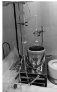
図 4-1 BDI およびその誘導体の調製に使用されるディーン・スタック装置
